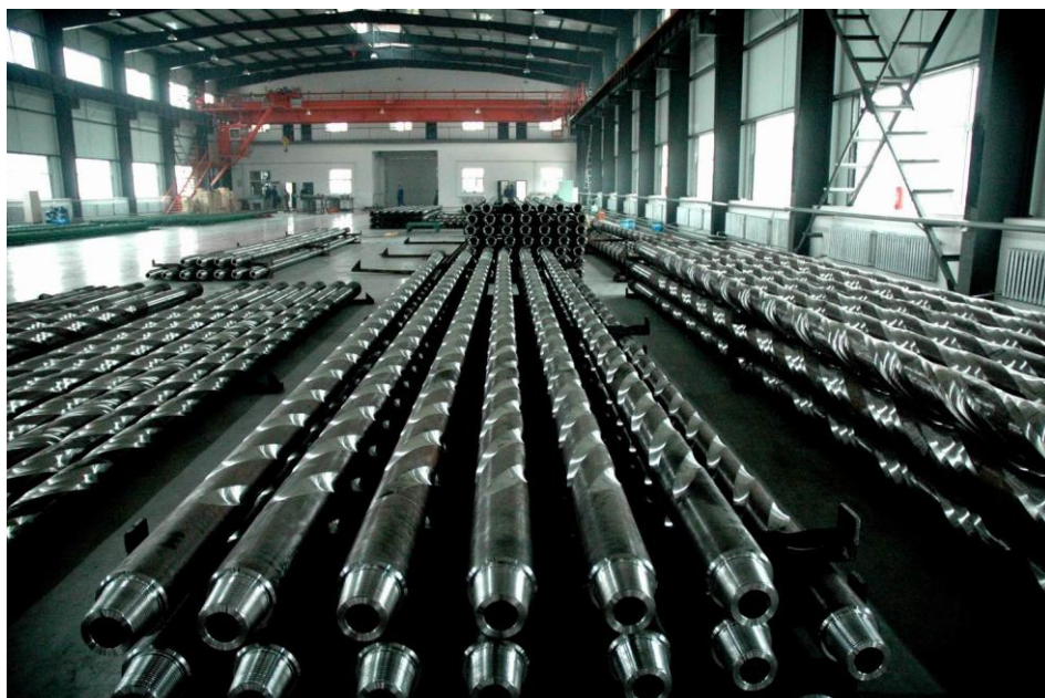
Рис. 21. Утяжелённые бурильные трубы со спиральной проточкой 13
